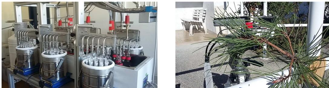
**Figura 2.** Línea de extracción de agua por medio de destilación criogénica con las muestras inmersas en el baño de temperatura y los tubos colectores congelados en nitrógeno líquido (izquierda). Medidas de intercambio gaseoso en ramas de *P. sylvestris* (derecha).
